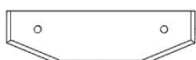
D05 PLANCHE DE RIVE DU PIGNON - W4L16854 (x2) 1 3/8 po x 1 1/2 po x 5 1/4 po (36x38x134)
