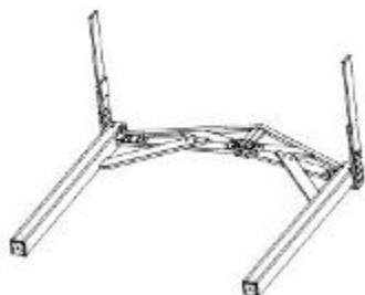
ASSEMBLAGE DES POTEaux ET PIGNONS
