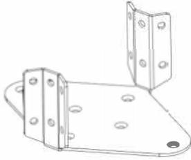
A4M02501 SOPORTE DE MONTAJE EN VENTILADOR
