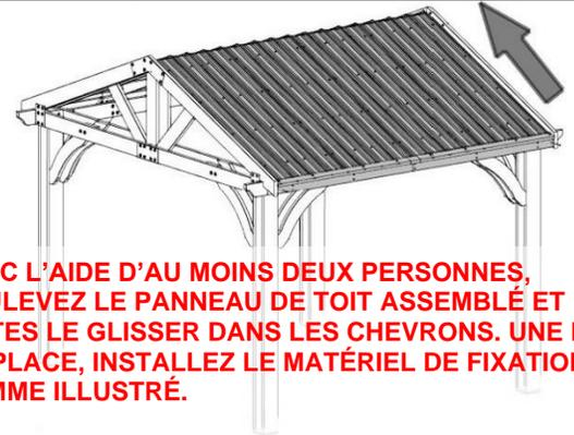
**AVEC L'AIDE D'AU MOINS DEUX PERSONNES, SOULEVEZ LE PANNEAU DE TOIT ASSEMBLÉ ET FAITES LE GLISSER DANS LES CHEVRONS. UNE FOIS EN PLACE, INSTALLEZ LE MATÉRIEL DE FIXATION COMME ILLUSTRÉ.**
