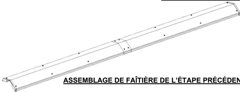
**NE MONTEZ PAS SUR LE TOIT POUR INSTALLER : LA FAÎTIÈRE A ÉTÉ CONÇUE POUR ÊTRE INSTALLÉE À L'AIDE D'UNE ÉCHELLE.**
