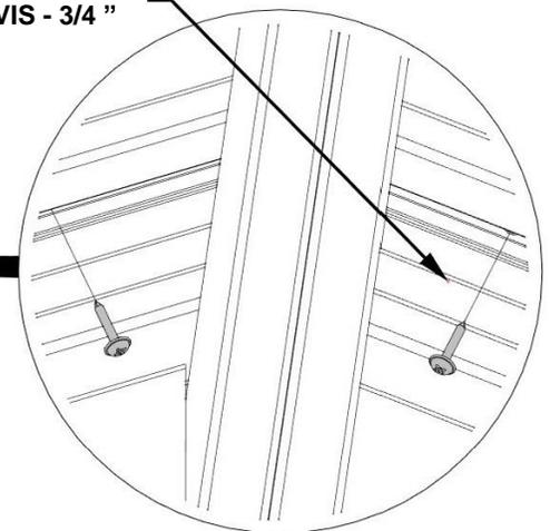
**INSTALLEZ LES VIS À TRAVERS LES AVANT-TRous DES PANNEAUX DE TOIT DANS LES PLANCHES DE MAINTIEN DE LA FAÎTIÈRE.**
