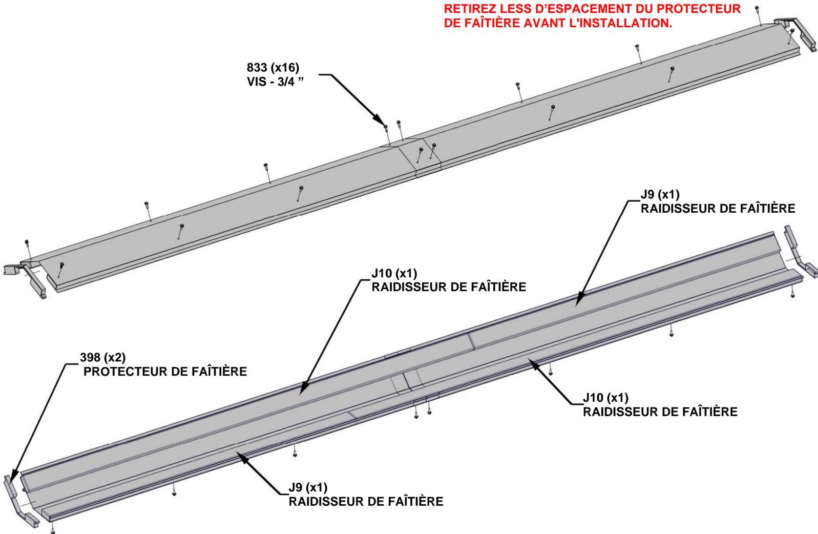
**LA FAÎTIÈRE DOIT ÊTRE SOULEVÉE PAR LE MILIEU POUR ÉVITER DE L'ENDOMMAGER AVANT L'INSTALLATION.**
