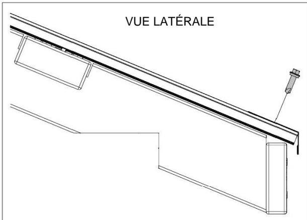
FAITES GLISSER LA BORDURE DANS L'ENTURE. ASSUREZ-VOUS QUE LES DEUX EXTRÉMITÉS SONT ALIGNÉES AVEC LE BORD DES PANNEAUX DE TOIT.
