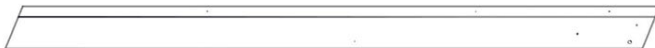
GP1 PANNEAU DE PIGNON - W2A03379 (x2) 2 13/16 po x 5 1/4 po x 80 3/16 po (72x134x2037)
