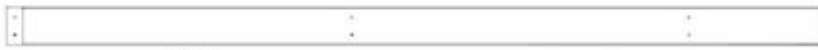
H05 PLANCHE DE REVÊTEMENT - W4L16392 (x2) 1 po x 3 3/8 po x 72 3/4 po (24x86x1849)
