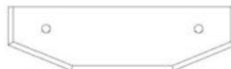
D05 PLANCHE DE RIVE DU PIGNON - W4L16753 (x1) 1 3/8 po x 1 1/2 po x 5 1/4 po (36x38x134)
