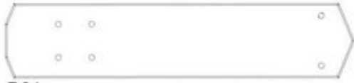
D01 PLANCHE DE RIVE DU PIGNON - W4L16415 (x2) 1 3/8 po x 5 1/4 po x 24 5/8 po (36x134x625)
