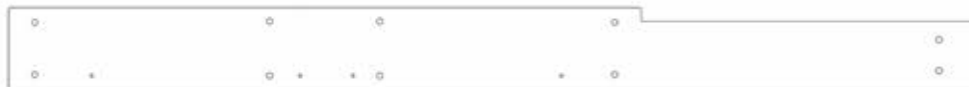
D1 SOPORTE DE LA VIGA DEL COLUMPIO - W4L17652 (x1) 1 3/8"x5 1/4"x62 3/8" (36x134x1585)
