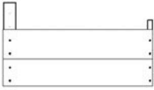
RP3 PANNEAU DE TOIT - W2A03758 (x1) 1 5/8 po x 15 1/2 po x 27 3/4 po (42 x 395 x 707)
