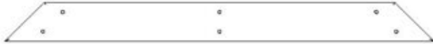
N04 PLANCHE DE RIVE DU PIGNON - W4L17920 (x2) 5/8 po x 2 3/8 po x 25 5/8 po (16 x 60 x 650)
