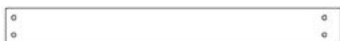
H16 LISSE MURALE - W4L17767 (x1) 1 po x 3 3/8 po x 30 1/4 po (24 x 86 x 767)
