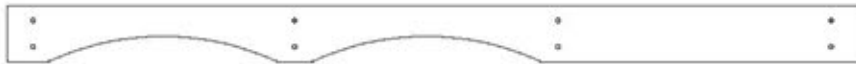
G14 LISSE INTERMÉDIAIRE - W4L17717 (x1) 1 po x 5 1/4 po x 80 1/2 po (24 x 134 x 2044)
