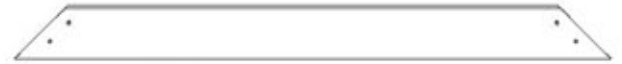
K903 PLANCHE DE RIVE DU PIGNON - W4L17970 (x2) 3/8 po x 3 3/8 po x 37 1/2 po (11 x 86 x 951)
