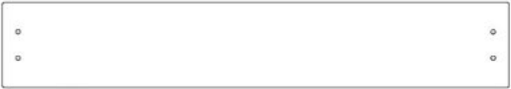
Y78 PLANCHE D'EXTRÉMITÉ DE MUR D'ESCALADE - W4L17935 (1) 5/8 po x 3 7/8 po x 22 7/8 po (16 x 98 x 580)
