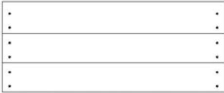
RP5 PANNEAU DE TOIT - W2A03760 (x1) 1 5/8 po x 15 5/8 po x 59 po (42 x 396 x 974)
