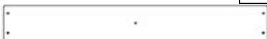
L03 PLANCHE DE PLANCHER - W4L17721 (x1) 5/8 po x 4 3/8 po x 32 1/8 po (16 x 112 x 815)
