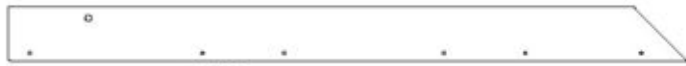
H24 CHEVRON DE TOIT - W4L17774 (x4) 1 po x 3 3/8 po x 42 5/8 po (24 x 86 x 1083)
