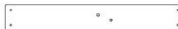
M75 PLANCHE DE MUR D'ESCALADE - W4L17933 (x4) 5/8 po x 3 3/8 po x 22 7/8 po (16 x 86 x 580)
