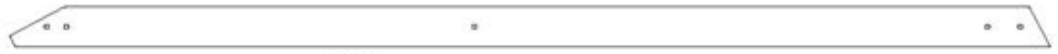
E80 CALE ANGULAIRE - W4L17938 (x2) 1 3/8 po x 3 3/8 po x 87 1/8 po (36 x 86 x 2212)
