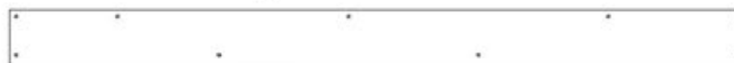
Y01 PLANCHE DE PLANCHER - W4L17730 (x1) 5/8 po x 3 7/8 po x 51 po (16 x 100 x 1296)
