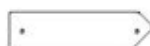
N03 PLANCHE DE RIVE DU PIGNON - W4L17919 (x4) 5/8 po x 2 3/8 po x 9 po (16 x 60 x 230)
