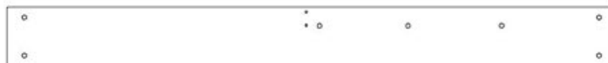
G06 LISSE DE PLANCHER - W4L17705 (x1) 1 po x 5 1/4 po x 53 5/8 po (24 x 134 x 1 363)
