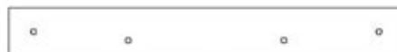
H11 PIQUET DE MARCHE - W4L17745 (x2) 1 po x 3 3/8 po x 27 3/8 po (24 x 86 x 695)
