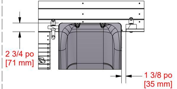
**CENTREZ LE TOBOGGAN DANS L'OUVERTURE EN UTILISANT LES DIMENSIONS INDIQUÉES. EN UTILISANT LE TOBOGGAN COMME GABARIT, PERCEZ TROIS (2) TROUS DE 3/8 PO [10 mm] À TRAVERS LA PLATEFORME POUR LA QUINCAILLERIE.**
