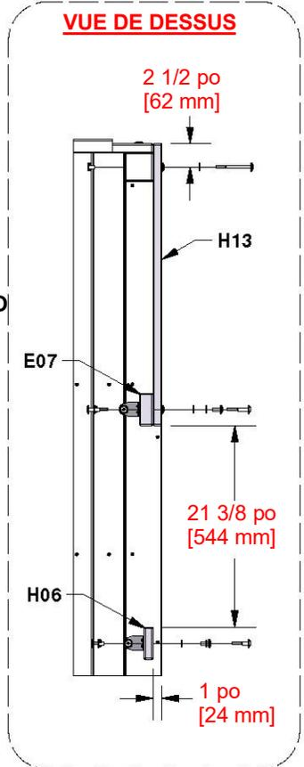
**EN UTILISANT LES SUPPORTS COMME GUIDE, PERCEZ UN TROU DE 3/8 po [10 mm] À TRAVERS LA PLATEFORME POUR LA QUINCAILLERIE.**
