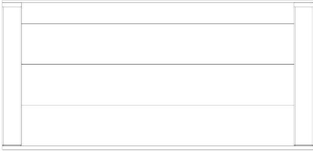
RP4 PANEL DE TECHO DEL MIRADOR - W2A03951 (x2) 1 5/8"x18 1/2"x38 3/8" (42x469x975)
