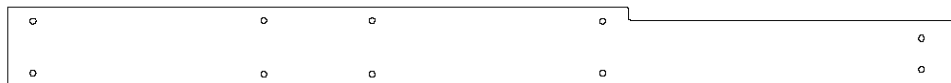
D1 SOPORTE DE LA VIGA DEL COLUMPIO - W4L19015 (x1) 1 3/8"x5 1/4"x62 3/8" (36x134x1585)
