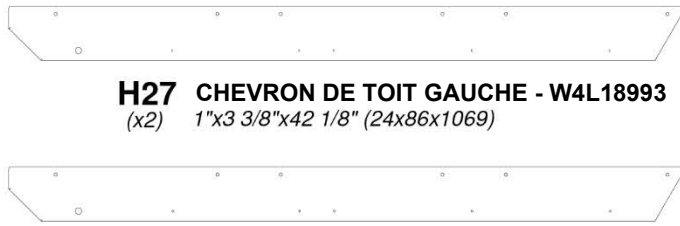
H28 CHEVRON DE TOIT DROIT - W4L18994 (x2) 1"x3 3/8"x42 1/8" (24x86x1069)
