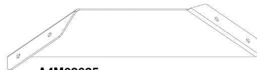
A4M02635 (x1) CALE ANGULAIRE MÉTALLIQUE
