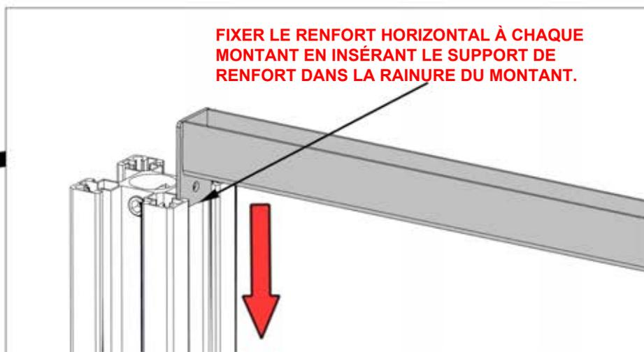
**FIXER LE RENFORT HORIZONTAL À CHAQUE MONTANT EN INSÉRANT LE SUPPORT DE RENFORT DANS LA RAINURE DU MONTANT.**
