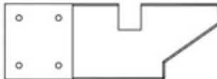
D03 EXTRÉMITÉ DE SOLIVE - W4L18002 (x1) 1 7/16 po x 5 1/4 po x 15 po (36x134x381)
