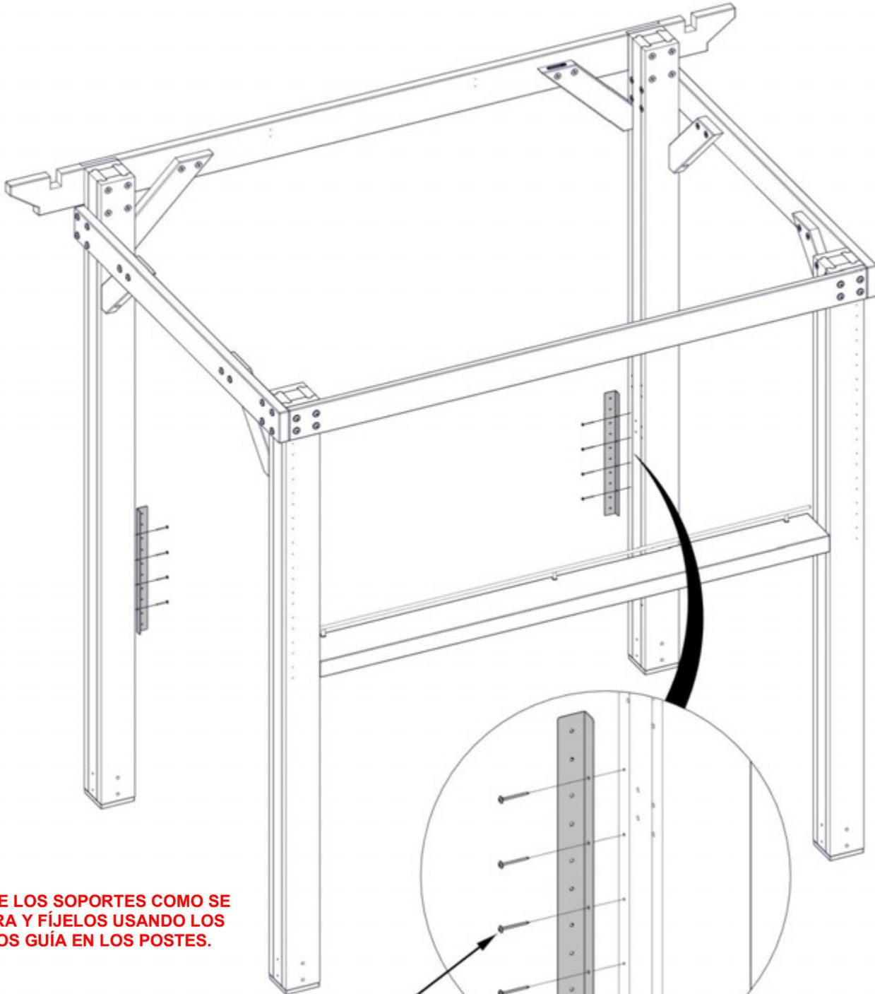
**ORIENTE LOS SOPORTES COMO SE MUESTRA Y FÍJELOS USANDO LOS ORIFICIOS GUÍA EN LOS POSTES.**
