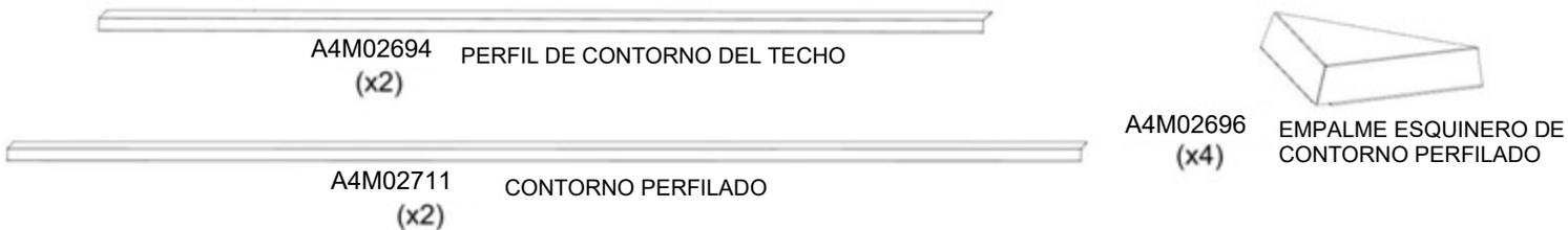
**FIJE EL LADO MÁS LARGO DEL PERFIL DE CONTORNO DEL TECHO EN LA PARTE SUPERIOR DEL PANEL DEL TECHO. ASEGÚRESE DE QUE CADA PIEZA DEL CONTORNO ESTÉ CENTRADO Y ATORNILLADO EN SU LUGAR. LUEGO FIJE EL EMPALME DE LA ESQUINA.**
