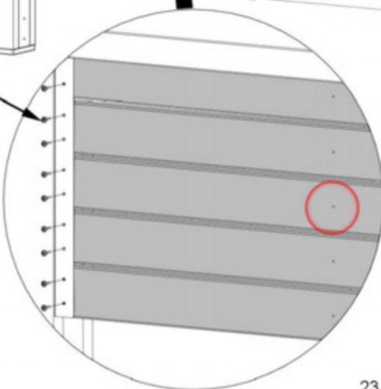
**FIJE LAS TABLAS H03 A LOS SOPORTES EN ESCUADRA. LOS DOS SUPERIORES DEBEN DESLIZARSE HACIA ARRIBA ENTRE EL SOPORTE Y LA MESA. ASEGÚRESE DE QUE LOS ORIFICIOS GUÍA MIREN HACIA AFUERA.**
