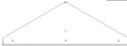
K01 PLANCHE DE RÉGLAGE DU PIC- W4L19554 (x1) 5/8"x5 1/4"x15 1/4" (16x134x388)
