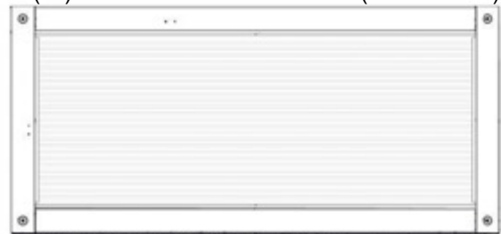
WA03 ASSEMBLAGE DE PANNEAU - W2A04163 (x1) 1 7/8"x21 13/16"x47 3/16" (48x554x1198)
