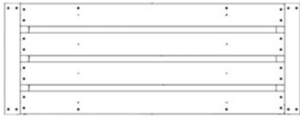
TB02 ASSEMBLAGE DE TABLE- W2A04152 (x1) 2 1/16"x16 1/16"x42 11/16" (52x408x1084)
