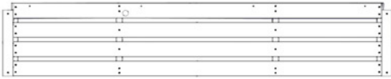
TB06 ASSEMBLAGE DE TABLE - W2A04165 (x1) 2 1/16"x16 1/16"x84 1/2" (52x408x2146)
