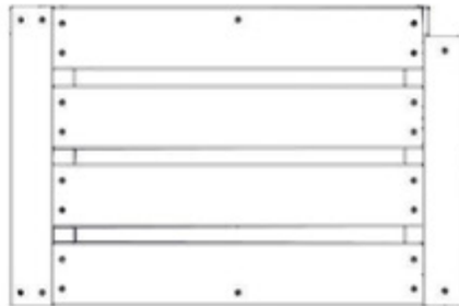
TB05 ASSEMBLAGE DE TABLE - W2A04160 (x1) 2 1/16"x16 1/16"x24 1/2" (52x408x620)
