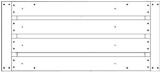
TB03 ASSEMBLAGE DE TABLE - W2A04153 (x1) 2 1/16"x16 1/16"x36 9/16" (52x408x929)
