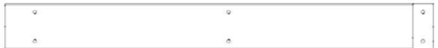
D04 PANNEAU DE LA BASE - W4L18705 (x1) 1 7/16 po x 5 1/4 po x 49 5/16 po (36x134x1252)
