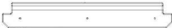
E01 PANNEAU DE REBORD - W4L18693 (x2) 1 7/16 po x 3 3/8 po x 22 7/16 po (36x86x570)
