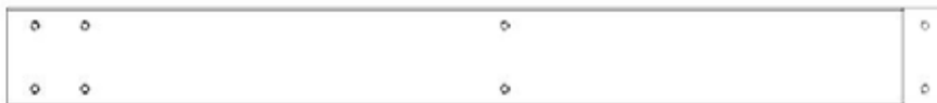
D05 PANNEAU DE LA BASE - W4L18706 (x1) 1 7/16 po x 5 1/4 po x 50 1/4 po (36x134x1276)
