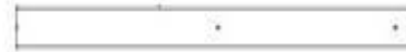
P16 PANNEAU DE CADRE DE TABLE - W4L18804 (x3) 1 7/16 PO x 1 7/16 PO x 13 1/8 PO (36x36x333)
