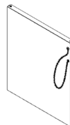
O3 ASSEMBLAGE DU PANNEAU LATÉRAL DE L'ARMOIRE DU FOUR À PIZZA- A4M03077 (x1) 1 3/4"x23 5/16"x26 7/16" (44x592x672)
