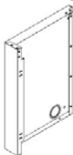
S1 ASSEMBLAGE DU PANNEAU LATÉRAL DE L'ARMOIRE D'ÉVIER A4M03094 (x1) 4 3/4"x23 3/8"x33 3/8" (121x594x848)
