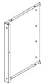
G1 MONTAGE DU MUR LATÉRAL D'ARMOIRE GAUCHE - A4M03029 (x1) 2 9/16"x23 3/8"x33 3/8" (65x594x848)
