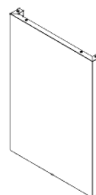
O5 ASSEMBLAGE DU PANNEAU LATÉRAL DE L'ARMOIRE DU FOUR À PIZZA - A4M03063 (x1) 2 5/8"x23 3/8"x33 3/8" (67x594x848)
