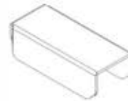
A5 SHELF BRACKET - A4M03141 (x8) 5/8"x7/8"x2 1/16" (16x22x53)
