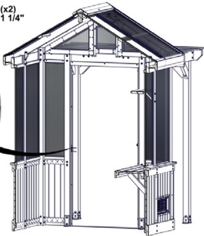
ATTACHEZ LE BAS-DE-PORTE EN UTILISANT LES TROUS PILOTES DANS LA PORTE COMME MONTRE
