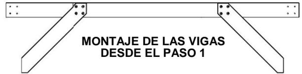
**NOTA: ALINEE EL MONTAJE DE LA VIGA DEL PASO 1 CON LOS ORIFICIOS DEL POSTE. FORME UN ÁNGULO RECTO CON EL MONTAJE DE LA VIGA Y CADA POSTE. AJUSTE TODOS LOS FIJADORES DEL PASO ANTERIOR.**
