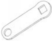
F04 LINKAGE STRAP - A4M02225 (x1) 1/8"x13/16"x2 5/8" (3x20x66)
