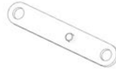
F03 LINKAGE STRAP - A4M02229 (x1) 1/2"x11/16"x3 13/16" (13x17x97)
