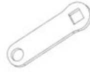
F04 LINKAGE STRAP - A4M02225 (x1) 1/8"x13/16"x2 5/8" (3x20x66)
