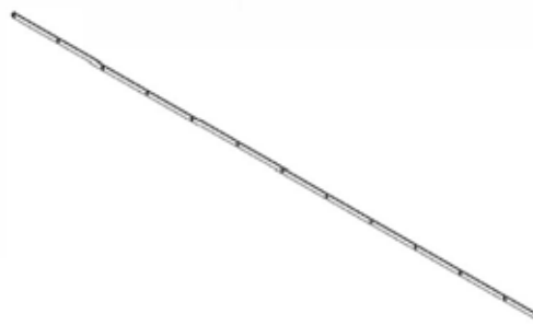
F02 SANGLE D'ATTACHE A PERSIENNE - A4M02130 (x4) 1/8 "x5 / 8" x81 7/16 "(3x16x2068)
