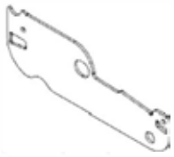
L02 PLAQUE LATÉRALE D'ENTRAÎNEMENT DU VOLET -A4M02134 (x1) 1/16"x2 3/16"x6 9/16" (2x55x167)
