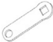
F04 LINKAGE STRAP - A4M02225 (x1) 1/8"x13/16"x2 5/8" (3x20x66)
