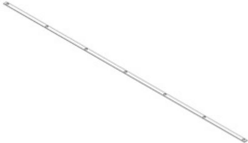
F01 FLAT BAR - A4M02129 (x4) 1/16"x1"x79 5/16" (2x25x2015)
