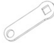
F04 LINKAGE STRAP - A4M02225 (x1) 1/8"x13/16"x2 5/8" (3x20x66)
