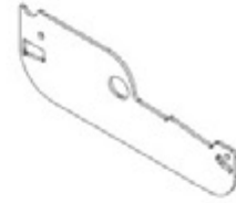
L03 LOUVER SIDE PLATE - A4M02334 (x47) 1/16"x2 3/16"x6 9/16" (2x55x167)
