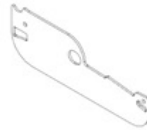
L03 LOUVER SIDE PLATE - A4M02334 (x46) 1/16"x2 3/16"x6 9/16" (2x55x167)
