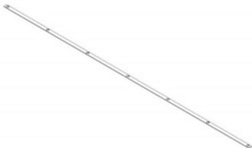
F01 BARRA PLANA - A4M02129 (x4) 1/16"x1"x79 5/16" (2x25x2015)
