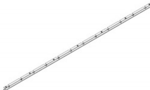
M01 SOPORTE DE REJILLA - A4M01991 (x2) 1"x1 15/16"x79 5/16" (25x49x2015)
