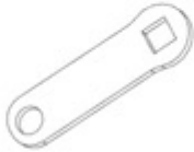
F04 LINKAGE STRAP - A4M02225 (x1) 1/8"x13/16"x2 5/8" (3x20x66)
