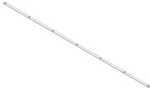
F01 FLAT BAR - A4M02129 (x4) 1/16"x1"x79 5/16" (2x25x2015)
