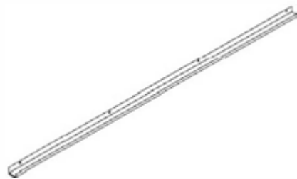
G03 GOUTTIÈRE - A4M01998
