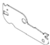
L02 PLAQUE LATÉRALE D'ENTRAÎNEMENT DU VOILET -A4M04139 (x1) 1/16"x2 3/16"x6 9/16" (2x55x167)
