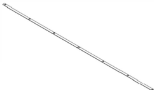
F01 BARRE PLATE - A4M02129 (x4) 1/16"x1"x79 5/16" (2x25x2015)
