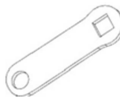
F04 - SANGLE DE LIAISON -A4M02225 (x1) 1/8"x13/16"x2 5/8" (3x20x66)
