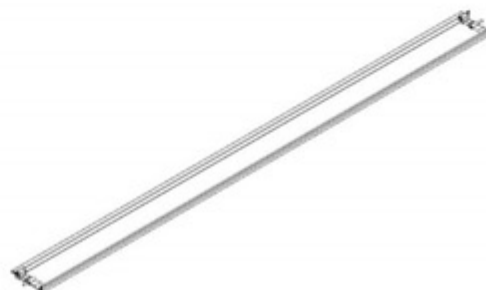
L01 CONJUNTO DE REJILLAS - A4M04137 (x24) 1 11/16"x7 5/8"x114 5/16" (42x194x2904)
