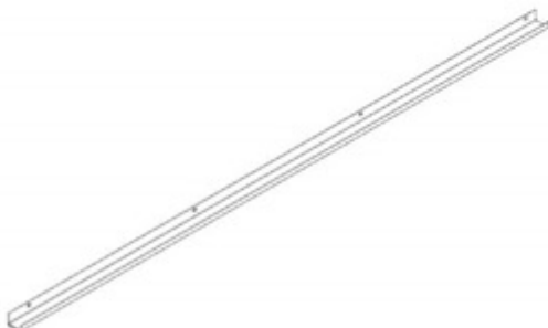
G03 CANALÓN-A4M01998 (x2) 1 9/16"x1 15/16"x79 3/8" (40x50x2017)
