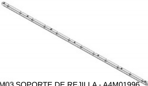
M03 SOPORTE DE REJILLA - A4M01996 (x1) 1"x1 15/16"x79 5/16" (25x49x2015)
