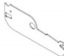
L03 PLACA LATERAL DE LA REJILLA - A4M04138 (x47) 1/16"x2 3/16"x6 9/16" (2x55x167)
