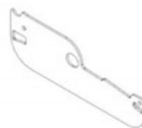
L03 PLACA LATERAL DE LA REJILLA - A4M04138 (x46) 1/16"x2 3/16"x6 9/16" (2x55x167)
