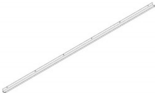
G01 CANALÓN-A4M01993 (x2) 1 9/16"x1 15/16"x108 13/16" (40x50x2764)
