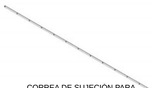
F02 CORREA DE SUJECCIÓN PARA REJILLAS - A4M02130 (x4) 1/8"x13/16"x81 9/16" (3x20x2072)
