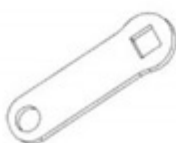
F04 CORREA DE ENLACE - A4M02225 (x1) 1/8"x13/16"x2 5/8" (3x20x66)
