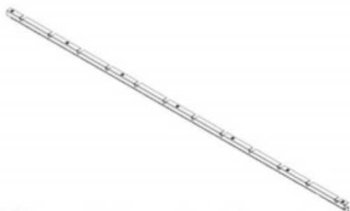
M02 SOPORTE DE REJILLA - A4M01992 (x1) 1"x1 15/16"x79 5/16" (25x49x2015)
