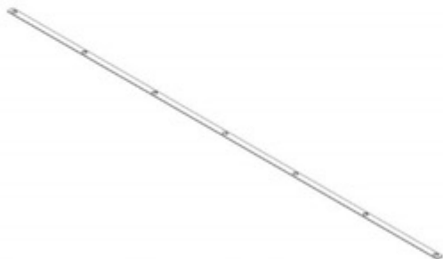
F01 BARRA PLANA - A4M02129 (x4) 1/16"x1"x79 5/16" (2x25x2015)
