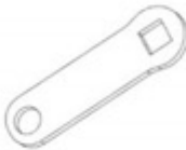
F04 (x1) CORREA DE ENLACE - A4M02225 1/8"x13/16"x2 5/8" (3x20x66)
