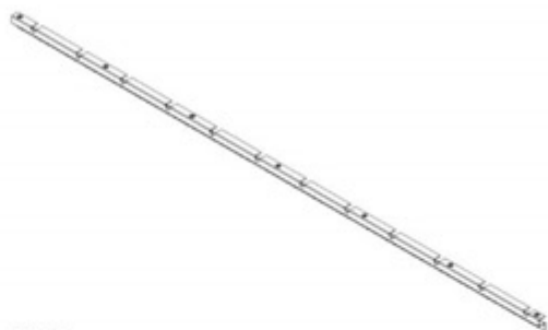
M03 SOPORTE DE REJILLA - A4M01996 (x1) 1"x1 15/16"x79 5/16" (25x49x2015)
