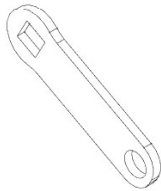
F04 LINKAGE STRAP - A4M02225 (x1) 1/8"x13/16"x2 5/8" (3x20x66)
