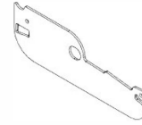
L03 PLAQUE LATÉRALE DE PERSIENNE -A4M02334 (x54) 1/16"x2 3/16"x6 9/16" (2x55x167)
