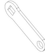
F04 - SANGLE DE LIAISON -A4M02225 (x1) 1/8"x13/16"x2 5/8" (3x20x66)
