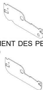
L03 GRILLE LATÉRALE -A4M02334 (x1) 1/16"x2 3/16"x6 9/16" (2x55x167)
