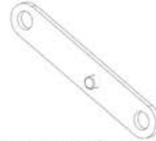
F03 LINKAGE STRAP - A4M02229 (x1) 1/2"x11/16"x3 13/16" (13x17x97)
