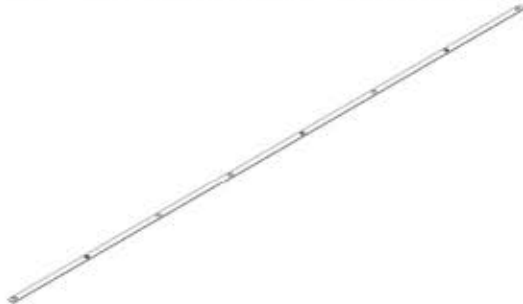
F01 FLAT BAR - A4M02572 (x4) 1/16"x1"x92 13/16" (2x25x2357)
