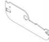
L03 LOUVER SIDE PLATE - A4M02334 (x54) 1/16"x2 3/16"x6 9/16" (2x55x167)
