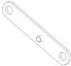
F03 LINKAGE STRAP - A4M02229 (x1) 1/2"x11/16"x3 13/16" (13x17x97)
