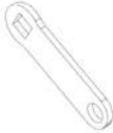
F04 LINKAGE STRAP - A4M02225 (x1) 1/8"x13/16"x2 5/8" (3x20x66)
