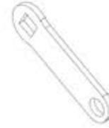
F04 LINKAGE STRAP - A4M02225 (x1) 1/8"x13/16"x2 5/8" (3x20x66)
