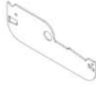
L03 LOUVER SIDE PLATE - A4M02334 (x55) 1/16"x2 3/16"x6 9/16" (2x55x167)
