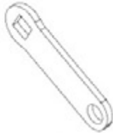
F04 LINKAGE STRAP - A4M02225 (x1) 1/8"x13/16"x2 5/8" (3x20x66)
