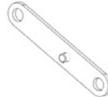
F03 LINKAGE STRAP - A4M02229 (x1) 1/2"x11/16"x3 13/16" (13x17x97)
