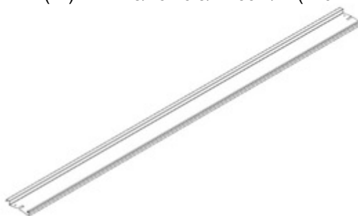
L01 LAMELLE - A4M01995 (x28) 1 11/16"x7 5/8"x114 5/16" (42x196x2904)
