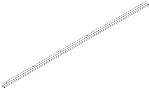
G01 CANALÓN - A4M01993 (x2) 1 9/16"x1 15/16"x108 7/8" (40x50x2764)
