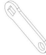
F04 CORREA DE ENLACE - A4M02225 (x1) 1/8"x13/16"x2 5/8" (3x20x66)
