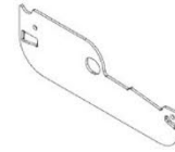
L03 PLACA LATERAL DE LA REJILLA - A4M02334 (x54) 1/16"x2 3/16"x6 9/16" (2x55x167)
