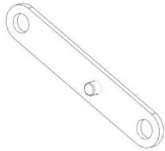
F03 CORREA DE ENLACE - A4M02229 (x1) 1/2"x11/16"x3 13/16" (13x17x97)
