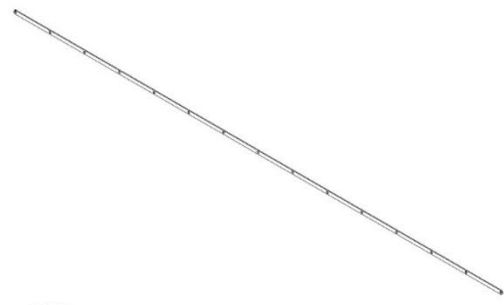
F02 CORREA DE AMARRE PARA REJILLAS - A4M02573 (x4) 1/8"x13/16"x95" (3x20x2414)
