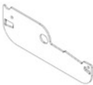
L03 LOUVER SIDE PLATE - A4M04138 (x55) 1/16"x2 3/16"x6 9/16" (2x55x167)
