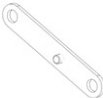
F03 LINKAGE STRAP - A4M02229 (x1) 1/2"x11/16"x3 13/16" (13x17x97)
