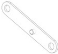
F03 LINKAGE STRAP - A4M02229 (x1) 1/2"x11/16"x3 13/16" (13x17x97)
