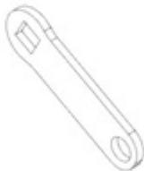
F04 LINKAGE STRAP - A4M02225 (x1) 1/8"x13/16"x2 5/8" (3x20x66)
