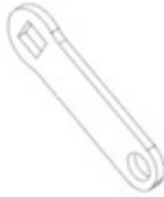
F04 LINKAGE STRAP - A4M02225 (x1) 1/8"x13/16"x2 5/8" (3x20x66)
