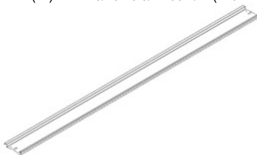
L01 LAMELLE - A4M04137 (x28) 1 11/16"x7 5/8"x114 5/16" (42x196x2904)
