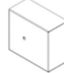
L03 PLAQUE LATÉRALE A PERSIENNES -A4M04138 (x55) 1/16 "x2 3/16" x6 9/16 "(2x55x167)
