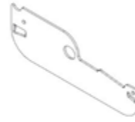
L03 PLAQUE LATÉRALE A PERSIENNES -A4M04138 (x55) 1/16 "x2 3/16" x6 9/16 "(2x55x167)
