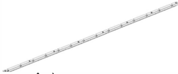
M01 BÂTI À PERSIENNES - A4M02577 (x1) 1"x1 15/16"x92 13/16" (25x49x2357)
