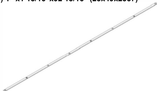
F01 BARRE PLATE -A4M02572 (x4) 1 /16"x1 "x92 13/16" (2x25x2357)
