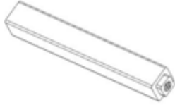
F05 PORTECLÉS -A4M02226 (x1) 1/2"x1/2"x3 3/4" (13x13x95)
