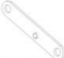
F03 LINKAGE STRAP - A4M02229 (x1) 1/2"x11/16"x3 13/16" (13x17x97)
