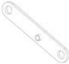
F03 LINKAGE STRAP - A4M02229 (x1) 1/2"x11/16"x3 13/16" (13x17x97)
