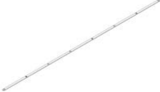
F01 FLAT BAR - A4M02572 (x4) 1/16"x1"x92 13/16" (2x25x2357)
