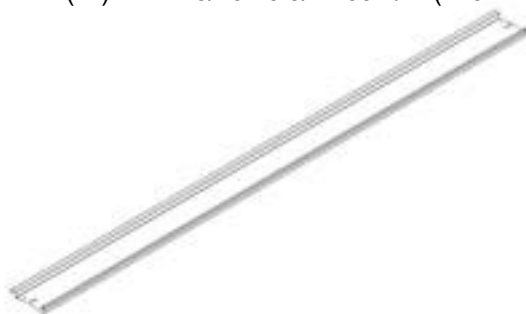
L01 LAMELLE - A4M04137 (x28) 1 11/16"x7 5/8"x114 5/16" (42x196x2904)
