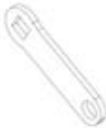
F04 - SANGLE DE LIAISON -A4M02225 (x1) 1/8"x13/16"x2 5/8" (3x20x66)
