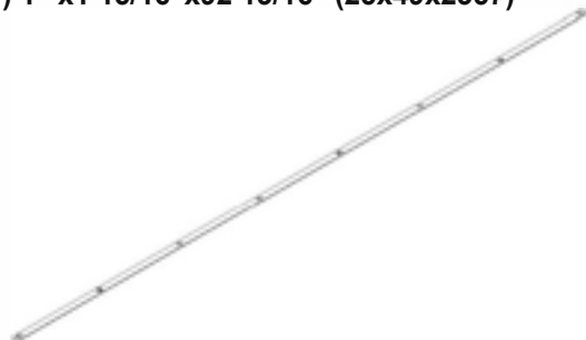
F01 BARRE PLATE -A4M02572 (x4) 1 1/16"x1 "x92 13/16" (2x25x2357)
