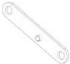
F03 - SANGLE DE LIAISON - A4M02229 (x1) 1/2"x11/16"x3 13/16" (13x17x97)
