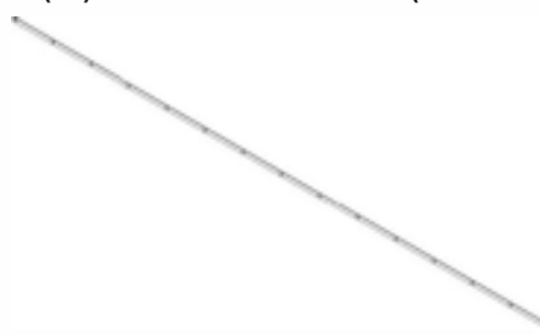
F02 SANGLE D'ATTACHE A PERSIENNE-A4M02573 (x4) 1/8"x13/16"x95" (3x20x2414)
