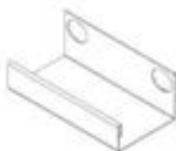
G05 EMPALME DE CANALÓN - A4M02004 (x2) 1 7/16"x2 1/16"x3 15/16" (36x52.5x100)
