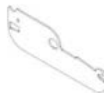
L03 PLACA LATERAL DE LA REJILLA - A4M04138 (x54) 1/16"x2 3/16"x6 9/16" (2x55x167)
