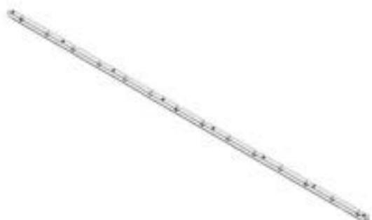
M02 SOPORTE DE REJILLA - A4M02578 (x1) 1"x1 15/16"x92 13/16" (25x49x2357)
