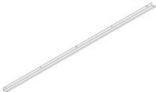
G03 CANALÓN - A4M02571 (x2) 1 9/16"x1 15/16"x92 7/8" (40x50x2359)
