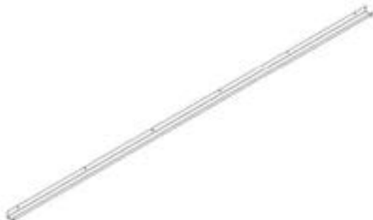
G01 CANALÓN - A4M01993 (x2) 1 9/16"x1 15/16"x108 7/8" (40x50x2764)
