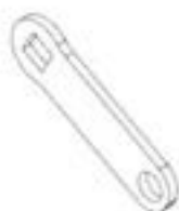
F04 (x1) CORREA DE ENLACE - A4M02225 1/8"x13/16"x2 5/8" (3x20x66)
