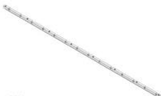
M03 SOPORTE DE REJILLA - A4M02579 (x1) 1"x1 15/16"x92 13/16" (25x49x2357)
