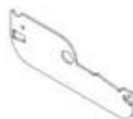
L03 (x55) PLACA LATERAL DE LA REJILLA - A4M04138 1/16"x2 3/16"x6 9/16" (2x55x167)
