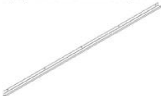
G02 CANALÓN - A4M02570 (x2) 1 9/16"x1 15/16"x92 7/8" (40x50x2359)
