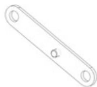
F03 LINKAGE STRAP - A4M02229 (x2) 1/2"x11/16"x3 13/16" (13x17x97)
