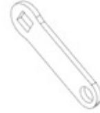
F04 LINKAGE STRAP - A4M02225 (x2) 1/8"x13/16"x2 5/8" (3x20x66)
