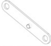
F03 LINKAGE STRAP - A4M02229 (x2) 1/2"x11/16"x3 13/16" (13x17x97)
