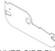
L03 LOUVER SIDE PLATE - A4M02334 (x66) 1/16"x2 3/16"x6 9/16" (2x55x167)
