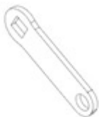
F04 LINKAGE STRAP - A4M02225 (x2) 1/8"x13/16"x2 5/8" (3x20x66)
