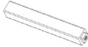
F05 PORTE-CLÉS - A4M02226 (x2) 1/2"x1/2"x3 3/4" (13x13x95)
