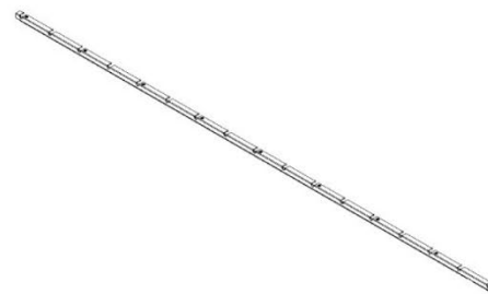
M02 SOPORTE DE REJILLA - A4M02594 (x1) 1"x1 15/16"x110 3/4" (25x49x2813)
