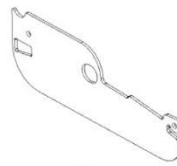
L03 PLACA LATERAL DE LA REJILLA - A4M02334 (x66) 1/16"x2 3/16"x6 9/16" (2x55x167)
