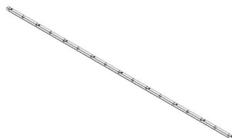
M03 SOPORTE DE REJILLA - A4M02595 (x1) 1"x1 15/16"x110 3/4" (25x49x2813)
