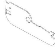
L03 PLACA LATERAL DE LA REJILLA - A4M02334 (x64) 1/16"x2 3/16"x6 9/16" (2x55x167)
