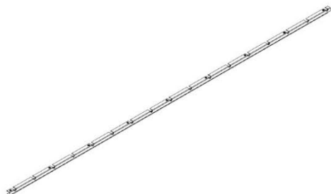
M01 SOPORTE DE REJILLA - A4M02593 (x1) 1"x1 15/16"x110 3/4" (25x49x2813)
