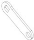
F04 LINKAGE STRAP - A4M02225 (x2) 1/8"x13/16"x2 5/8" (3x20x66)
