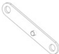
F03 LINKAGE STRAP - A4M02229 (x2) 1/2"x11/16"x3 13/16" (13x17x97)
