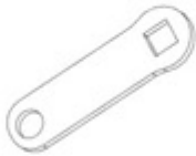
F04 LINKAGE STRAP - A4M02225 (x1) 1/8"x13/16"x2 5/8" (3x20x66)
