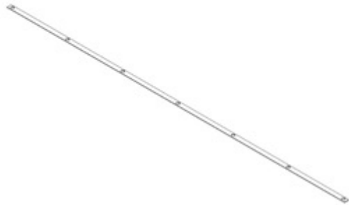
F01 FLAT BAR - A4M02129 (x4) 1/16"x1"x79 5/16" (2x25x2015)
