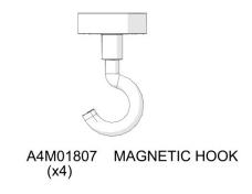
MAGNETIC HOOKS CAN BE ATTACHED ON ANY METAL SURFACE ON THE GAZEBO. FOR MAXIMUM STRENGTH AND SUPPORT, IT IS RECOMMENDED TO ATTACH ON BOTTOM SIDE OF BACK OR SIDE BEAMS.
