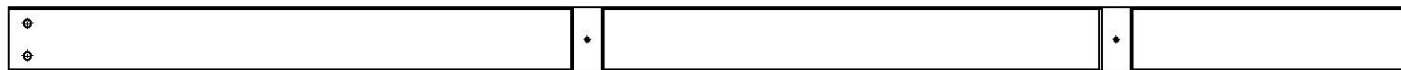
E3 | PLANCHE DE REVÊTEMENT - W4L16239 (x8) | 1 7/16 po x 3 3/8 po x 73 1/4 po (36x86x1861)
