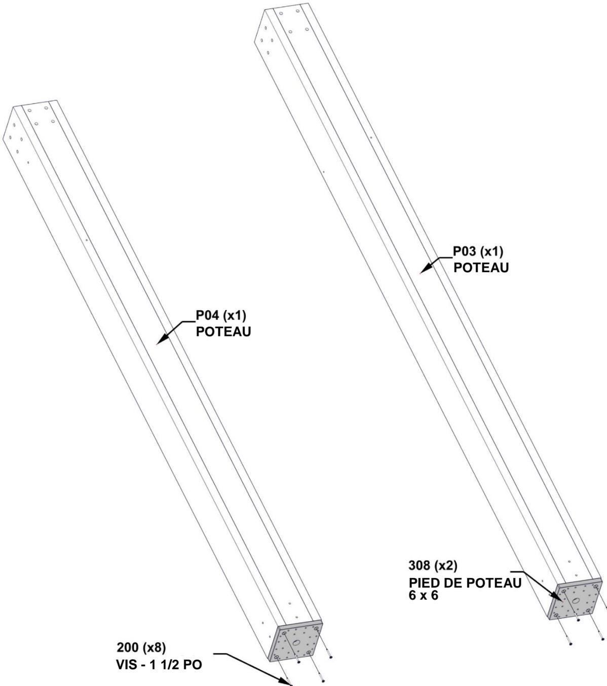
**ALIGNÉZ LE PIED DE POTEAU ET PERCEZ DES AVANT-TROUS DE 1/8 PO (3 mm) POUR LA FIXATION DE LA QUINCAILLERIE**
