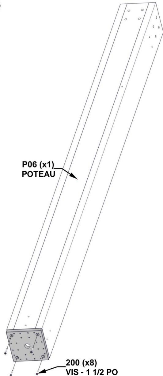
**ALIGNEZ LE PIED DE POTEAU ET PERCEZ DES AVANT-TROUS DE 1/8 PO (3 mm) POUR LA FIXATION DE LA QUINCAILLERIE**
