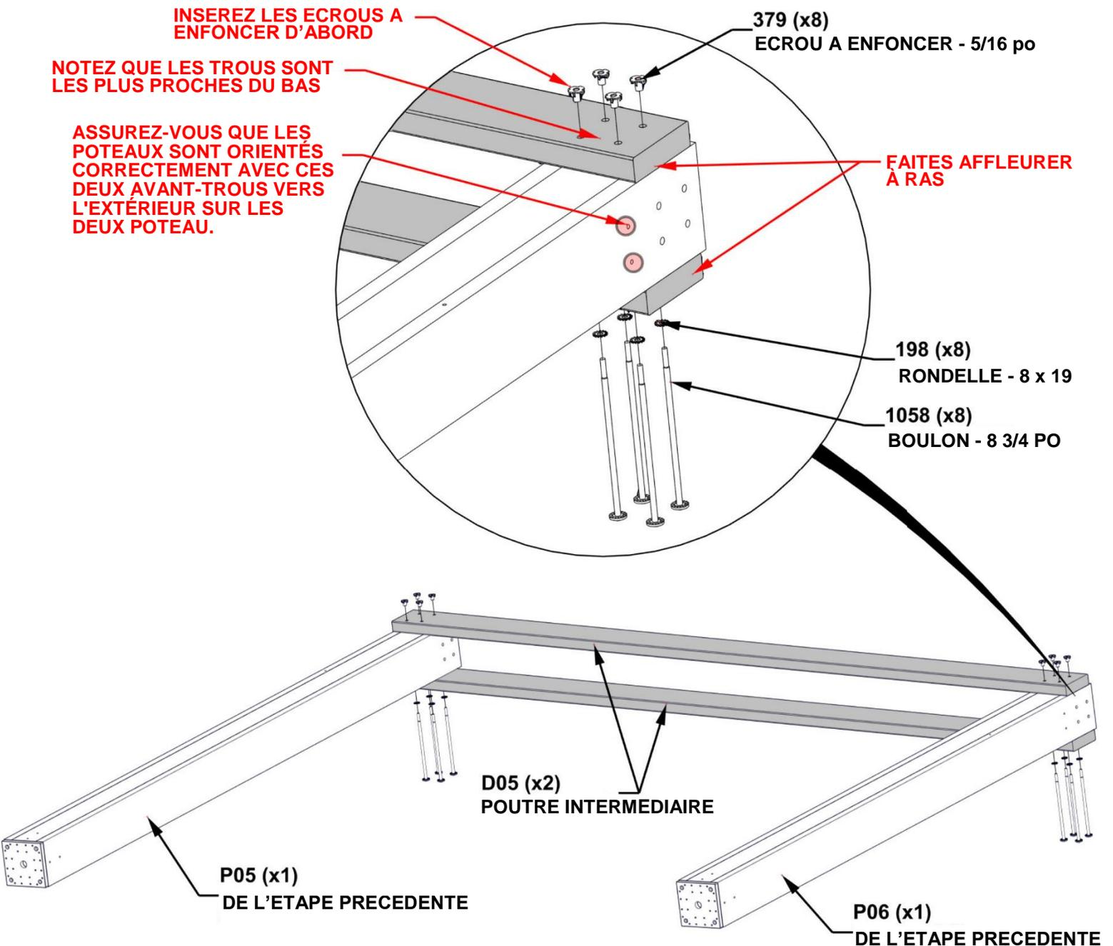
**PLACEZ L'ASSEMBLAGE CENTRAL SUR LE CÔTÉ**
