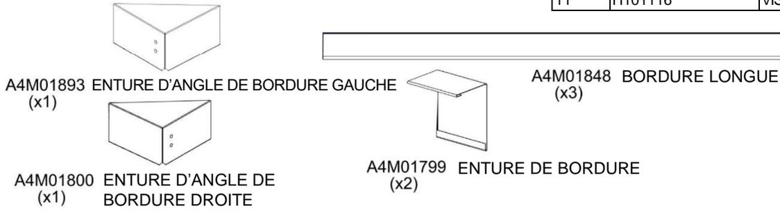
DISPOSEZ LA GARNITURE DE BORD DE TOIT, L'ÉPISSE DE GARNITURE ET L'ÉPISSE D'ANGLE COMME INDIQUÉ CI-DESSOUS. GLISSEZ LES MORCEAUX DE GARNITURE DANS LES ÉPISSES. FIXEZ LES ÉPISSES D'ANGLE EN LES FAISANT GLISSER SUR LA GARNITURE DE BORD. VISSEZ COMME INDIQUÉ DANS LE DÉTAIL.
