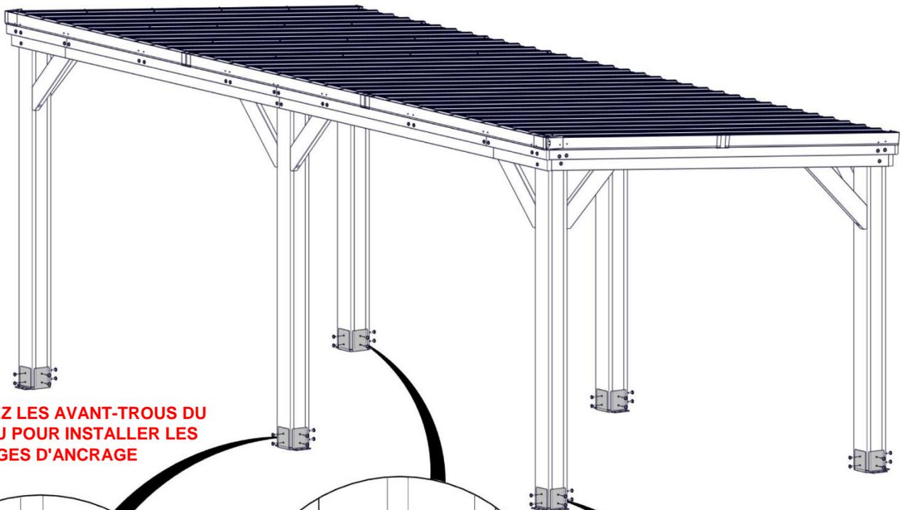
UTILISEZ LES AVANT-TROUS DU POTEAU POUR INSTALLER LES RÉGLAGES D'ANCRAGE
