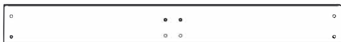
G02 BORDURE D'AVANT - TOIT - W4L19626 (x1) 15/16 po x 5 1/4 po x 44 1/8 po (24x134x1120)
