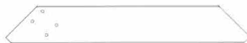
D02 CORBEAU AVEC ÉTIQUETTE - W2A03544 (x1) 1 7/16 po x 5 1/4 po x 34 7/16 po (36x134x874)
