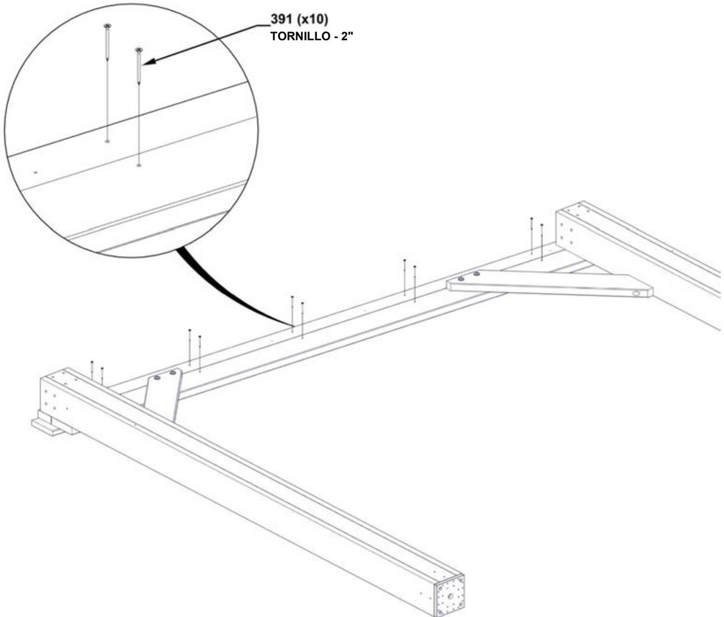
**AJUSTE EL MONTAJE DEL LADO IZQUIERDO A LA PARTE LATERAL.**
