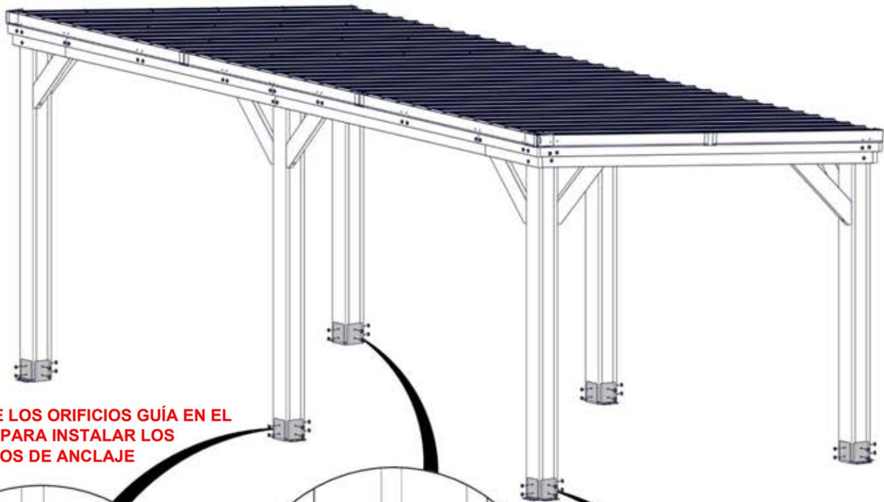
UTILICE LOS ORIFICIOS GUÍA EN EL POSTE PARA INSTALAR LOS MADEROS DE ANCLAJE
