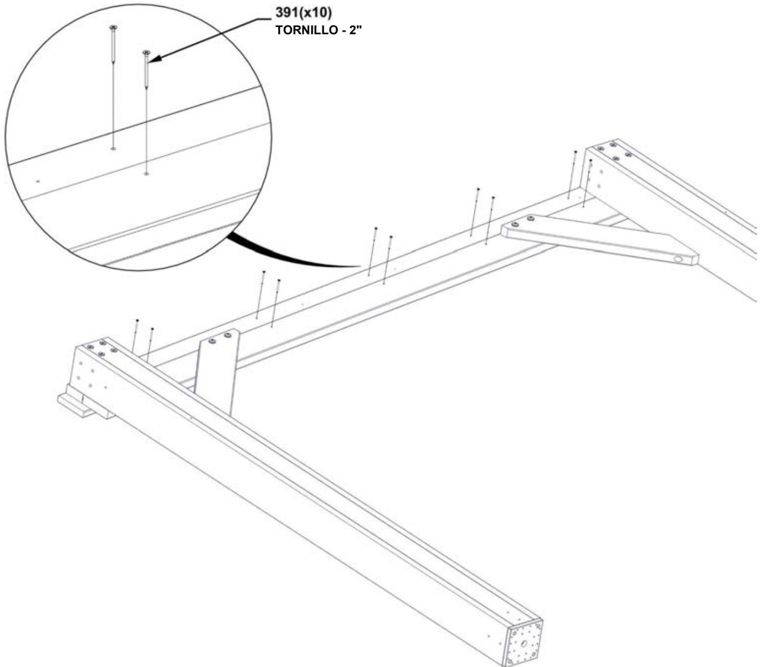
**AJUSTE EL MONTAJE DEL LADO DERECHO A LA PARTE LATERAL.**
