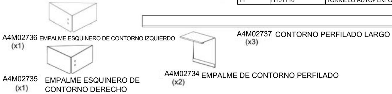
DISPONGA EL CONTORNO PERFILADO, EL EMPALME DE CONTORNO Y EL EMPALME ESQUINERO COMO SE MUESTRA A CONTINUACIÓN. DESLICE LAS PIEZAS DE CONTORNO EN LOS EMPALMES. FIJE LOS EMPALMES DE LAS ESQUINAS: DESLÍCELOS SOBRE EL CONTORNO PERFILADO. ATORNILLE COMO SE INDICA EN EL DETALLE.
