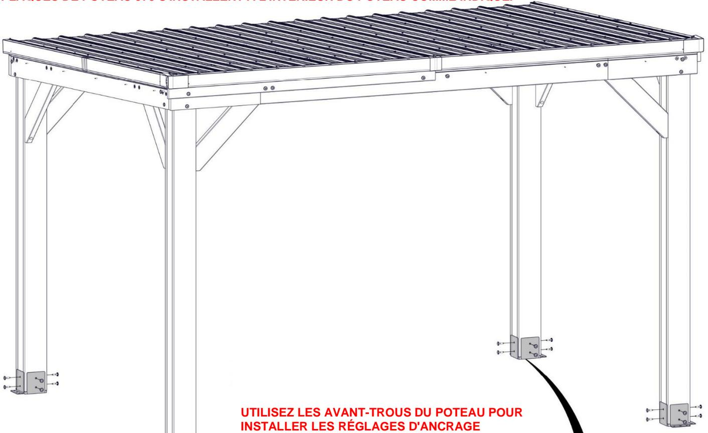
UTILISEZ LES AVANT-TROUS DU POTEAU POUR INSTALLER LES RÉGLAGES D'ANCRAGE
