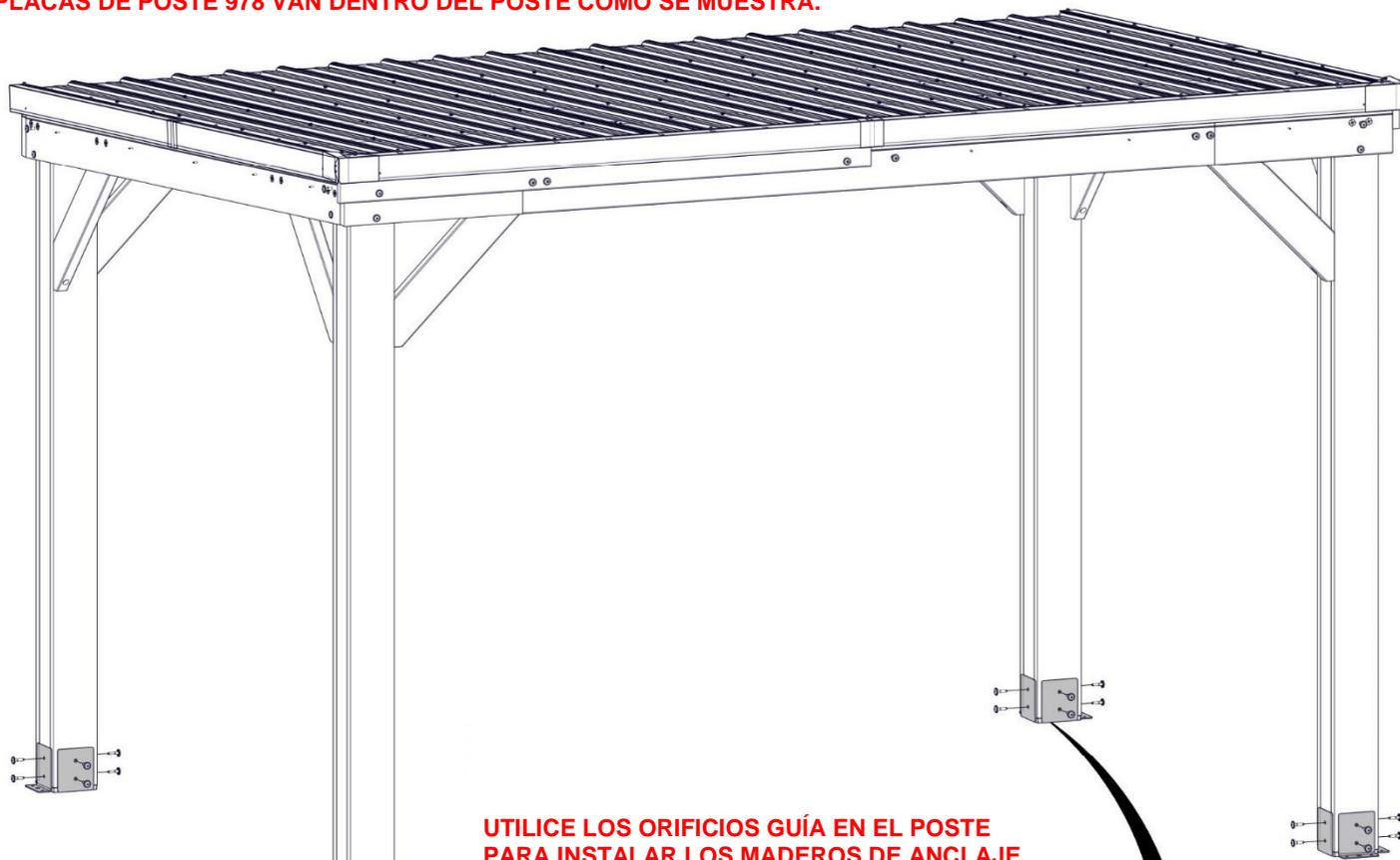
UTILICE LOS ORIFICIOS GUÍA EN EL POSTE PARA INSTALAR LOS MADEROS DE ANCLAJE
