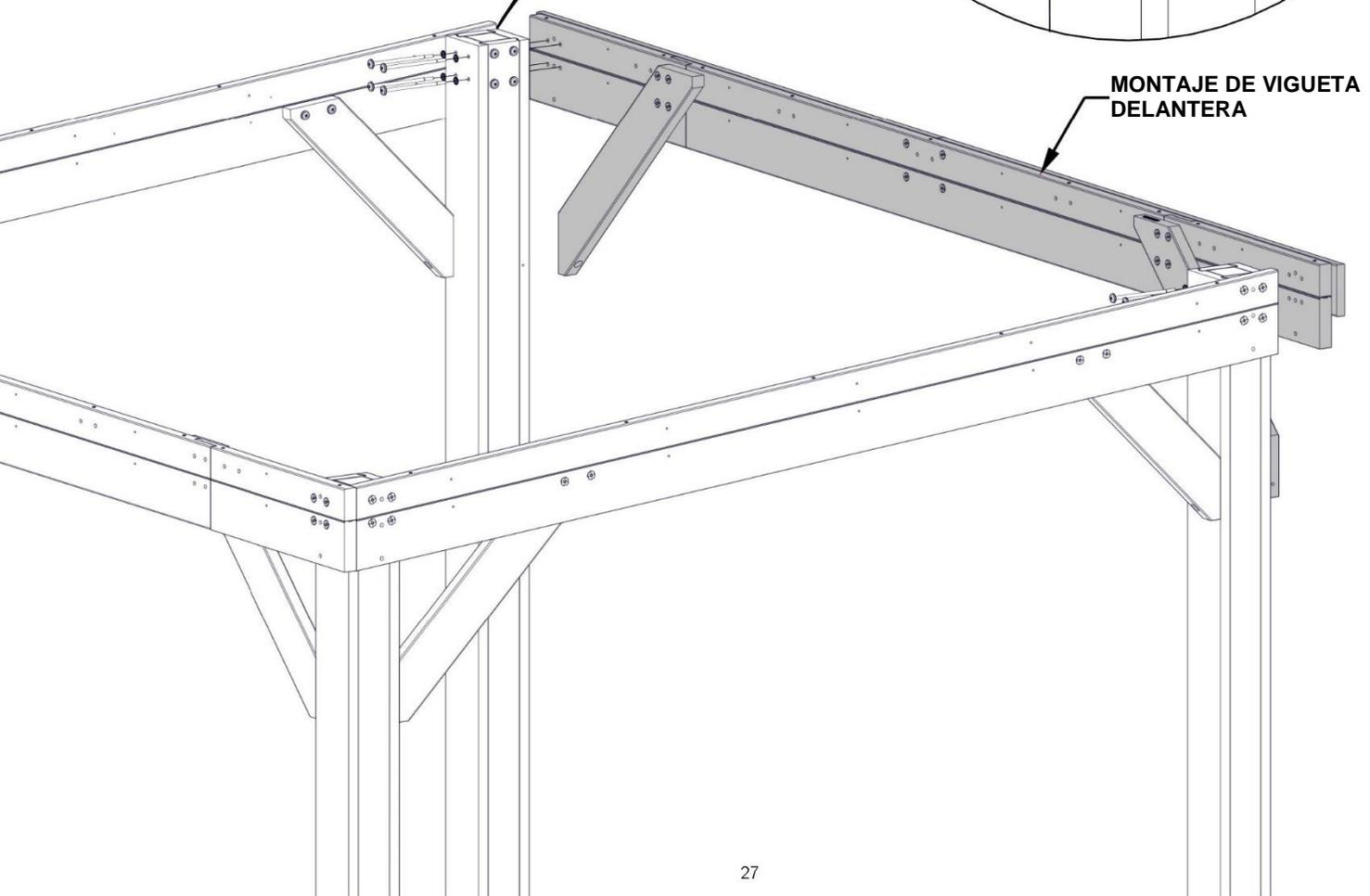
MONTAJE DE VIGUETA DELANTERA
